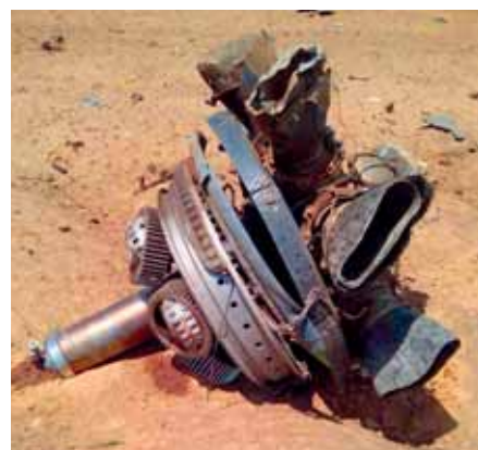
На месте катастрофы A400M близ аэропорта Севильи 9 мая 2015 г. Справа – фрагмент редуктора одного из двигателей
